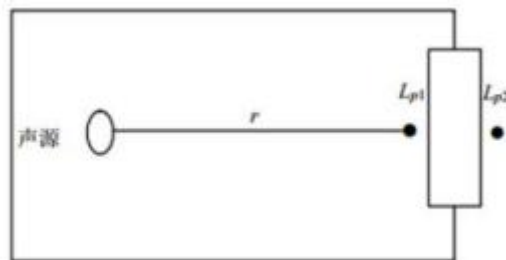
图 4-2 室内声源等效为室外声源图例
