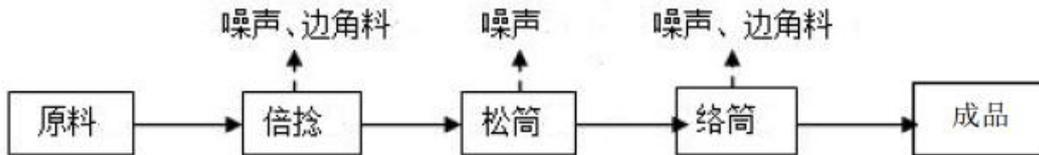
图2 分纱工艺流程示意图
