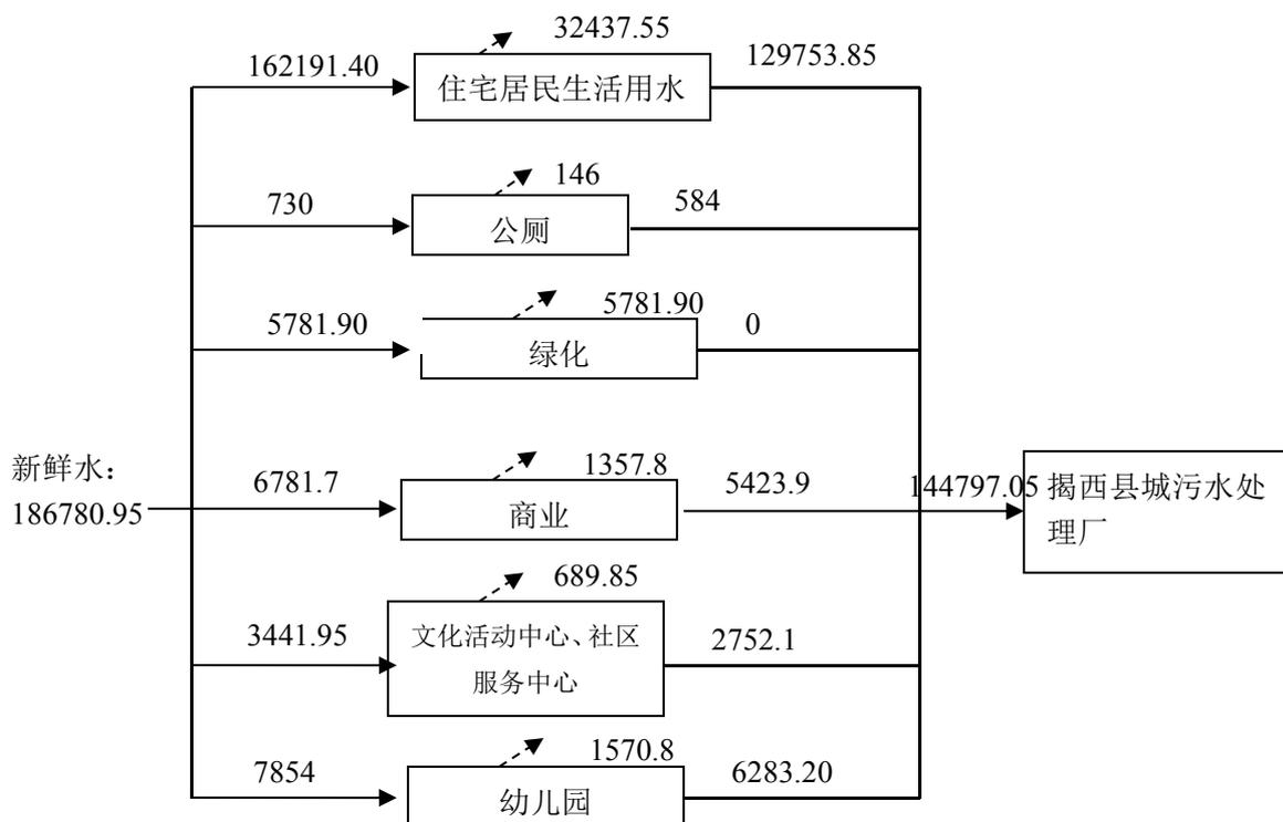
图 1 本项目水平衡图（单位：m<sup>3</sup>/a）
