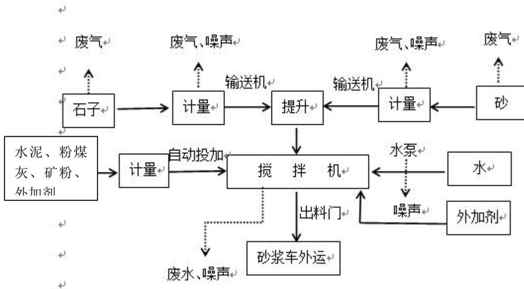
图 5 项目商品混凝土生产工艺流程图
