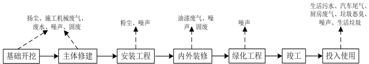
图 4 施工期工艺流程图
