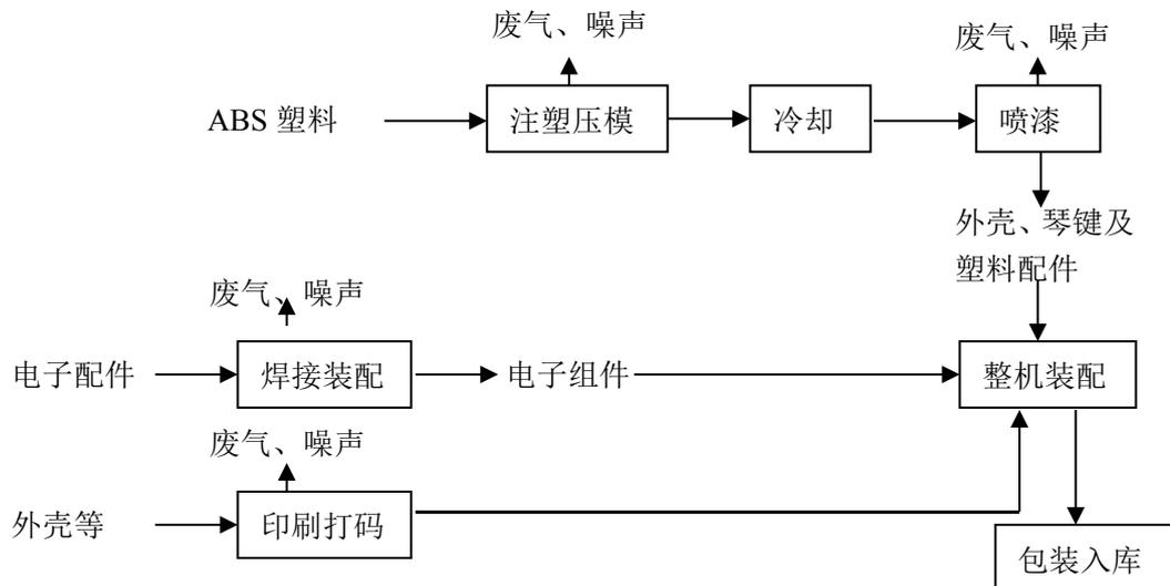
ABS 塑料经过加热后按照特定的模型注塑成电子琴外壳、琴键及塑料配件半成品等，经过冷却后，将半成品部分需要喷漆进行喷漆；电子配件经过焊接装配成电子组件；电子琴的外壳进行印刷打码；将打码后的外壳、电子组件和琴键、塑料配件等进行组装成成品。
