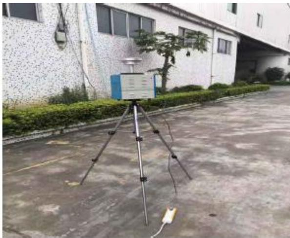
附图 (c) 无组织废气监测图
