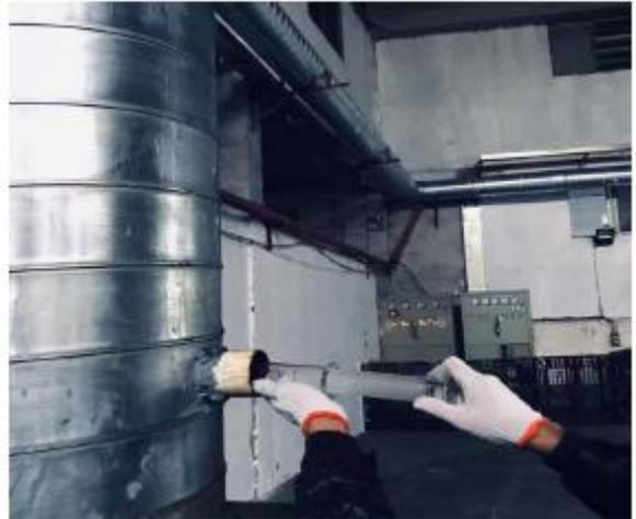
附图 (b) 有组织废气采样图
