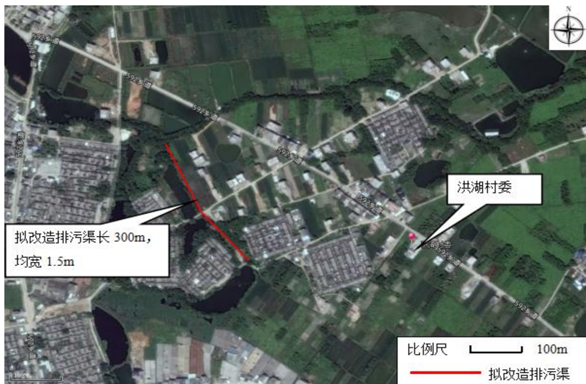
图 1-5 排污渠改造工程分布图
