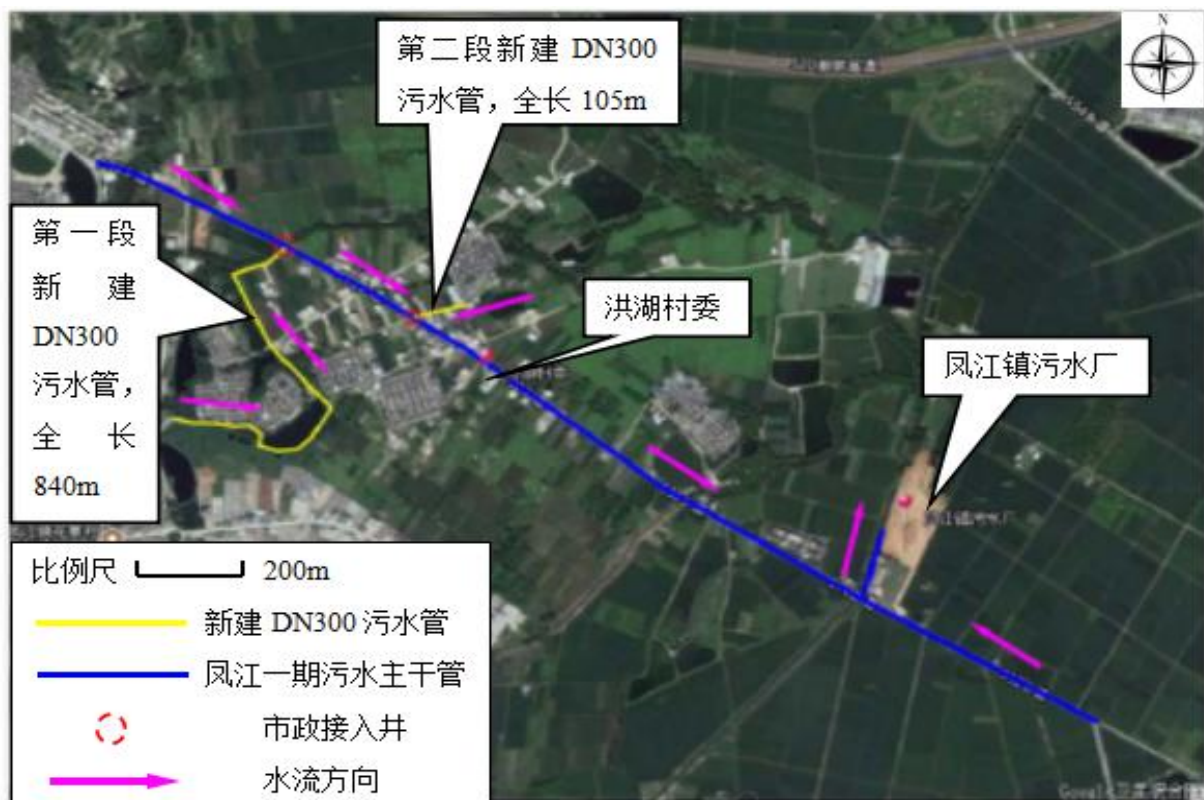
图 1-2 污水收集管网平面布置图总图
