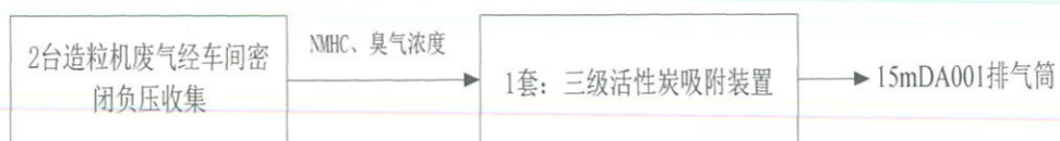
图 4-1 项目废气处理工艺流程图
