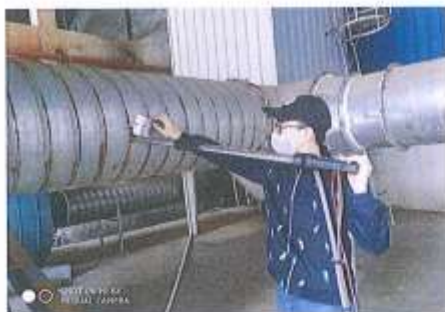
图四 粉尘废气1号采样口(处理前)
