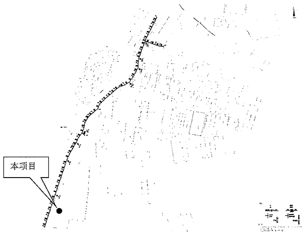
图 4-3 贡山村污水处理站纳污管网图
