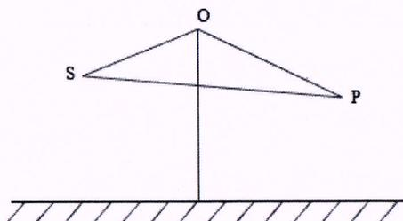
图 A.5 无限长声屏障示意图
