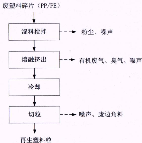
图 2-2 再生塑料粒生产工艺流程图
