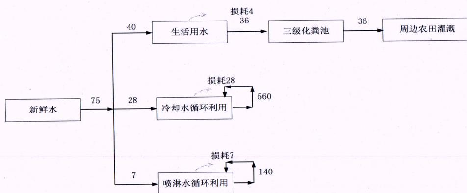
图 2-1 项目用水平衡示意图（单位：t/a）
