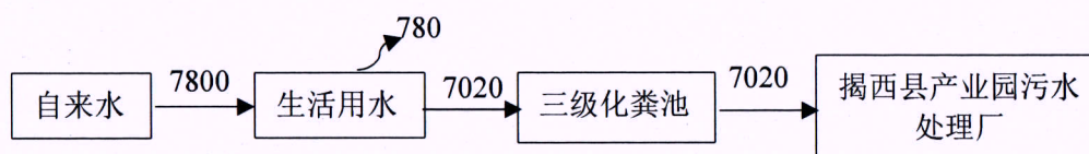
图 2-1 项目水平衡图 (t/a)
