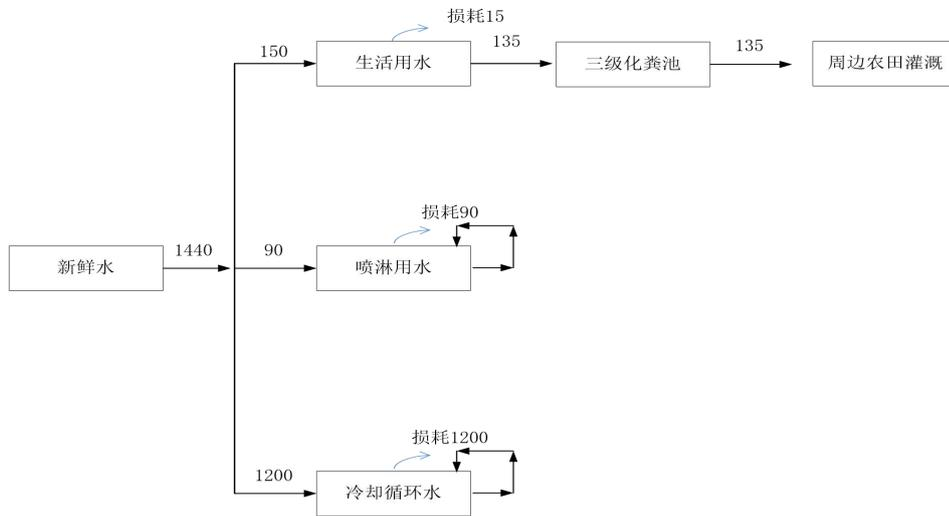
图 2-1 项目用水平衡示意图（单位：t/a）
