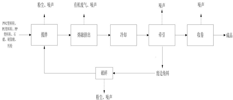
图 2-3 填充绳、绕包带生产工艺流程图
