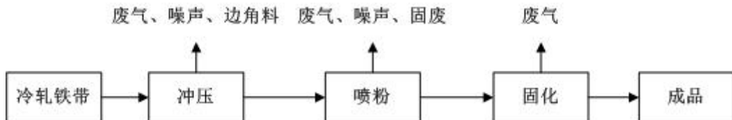
图 2-5 铁盘片生产工艺流程图
