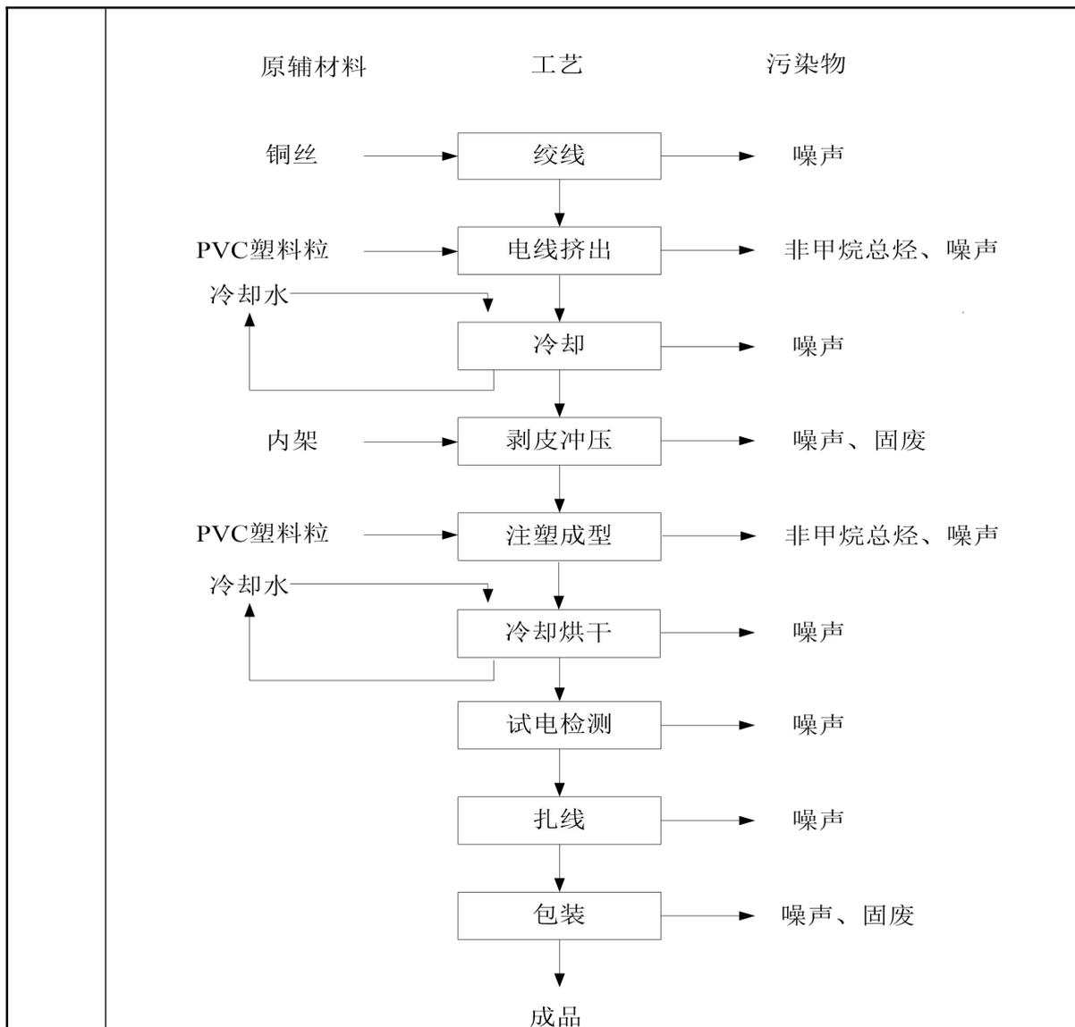
图2-3 电源线生产工艺流程及产污节点图
