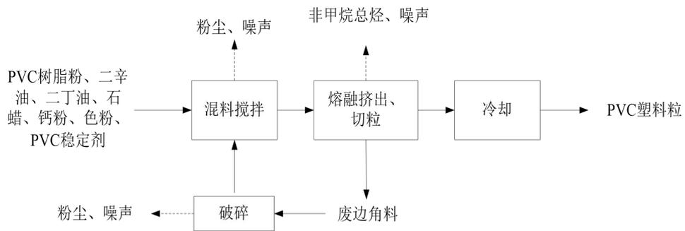
图 2-2 PVC 塑料粒生产工艺流程图
