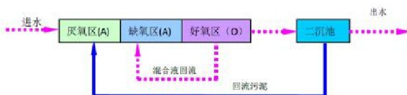
图7-1 传统AAO法工艺流程图
