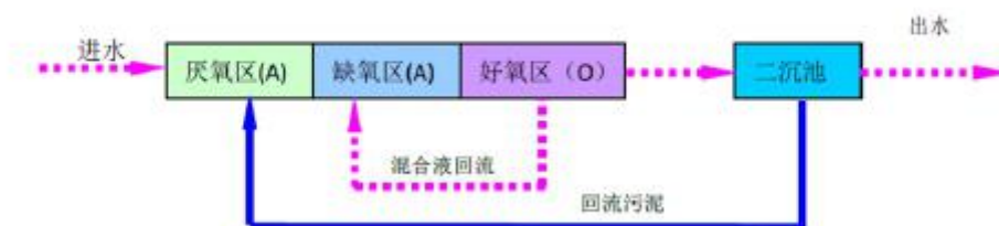
图7-1 传统AAO法工艺流程图
