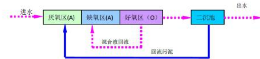
图7-1 传统AAO法工艺流程图
