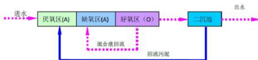
图7-1 传统AAO法工艺流程图
