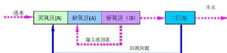
图7-1 传统AAO法工艺流程图
