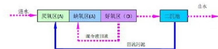
图7-1 传统AAO法工艺流程图
