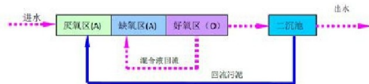
图7-1 传统AAO法工艺流程图
