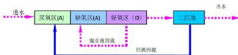
图7-1 传统AAO法工艺流程图
