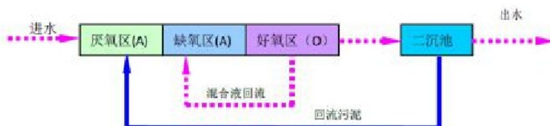
图7-1 传统AAO法工艺流程图
