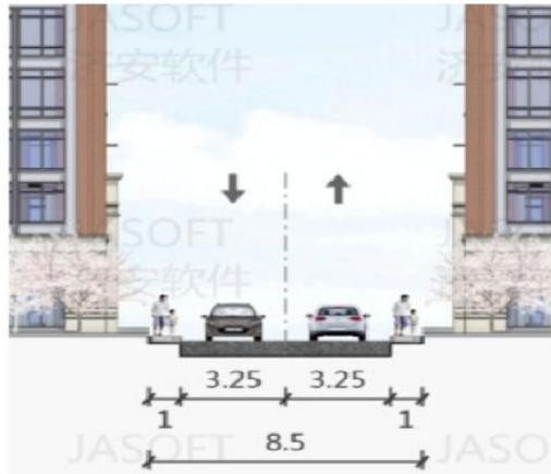
图 1-18 国道 G238 线河中支线标准横断面布置示意图 (单位: m)
