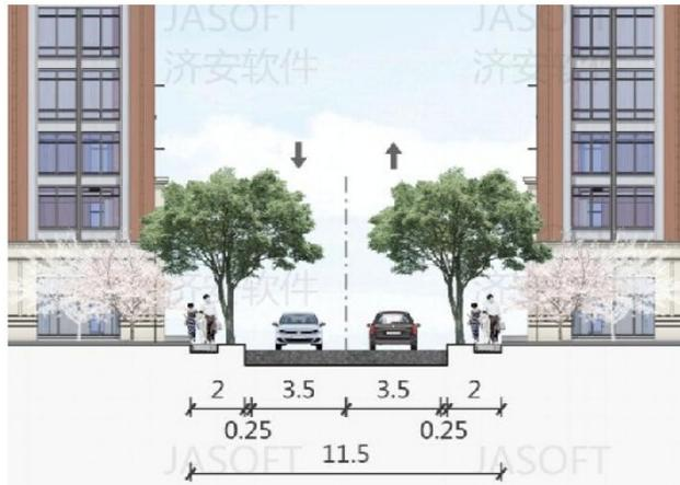
图 1-19 西堤路南段标准横断面布置示意图（单位：m）
