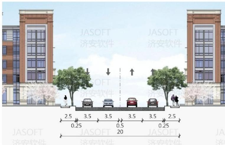
图 1-7 城东大道标准横断面布置示意图（单位：m）
