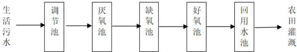
图 4-1 生活污水处理工艺流程
