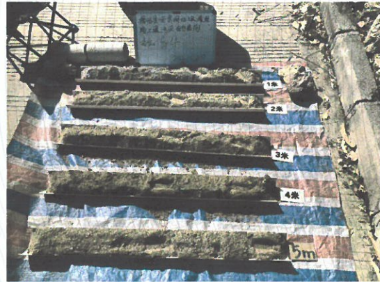
照片4 S4 土壤柱状图
