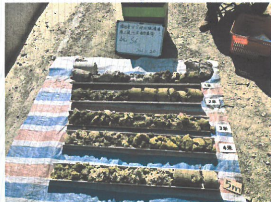
照片6 S6 土壤柱状图
