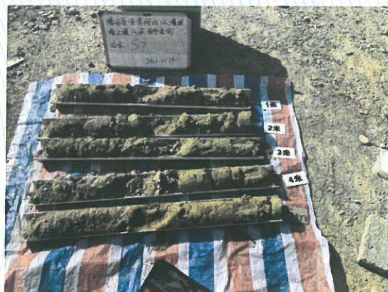
照片7 S7 土壤柱状图
