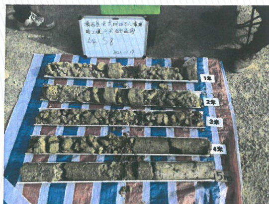
照片8 S8 土壤柱状图
