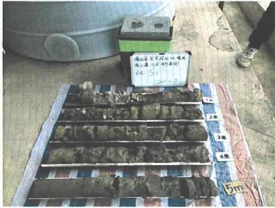
照片1 S1 土壤柱状图
