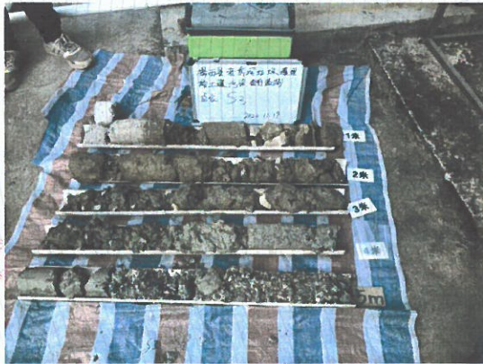
照片3 S3 土壤柱状图
