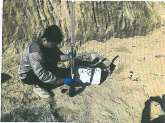
照片3 W3 地下水采样图
