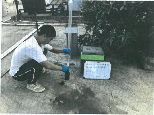
照片1 W1 地下水采样图
