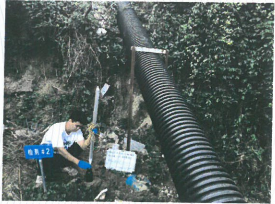
照片2 W2 地下水采样图
