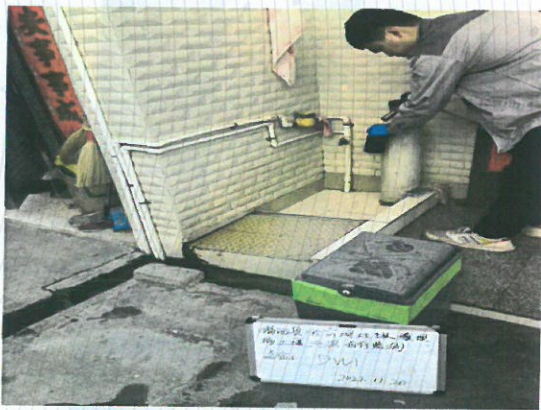
照片5 DW1 地下水采样图
