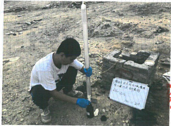
照片4 W4 地下水采样图
